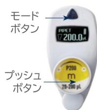
ピペットマン M は、シングルチャンネルで 0.5  $\mu\text{L}$  から 10 mL、マルチチャンネルで 0.5  $\mu\text{L}$  から 1200  $\mu\text{L}$  の 20 モデルがあります。
