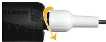
図16 ピストンの取り外し方
