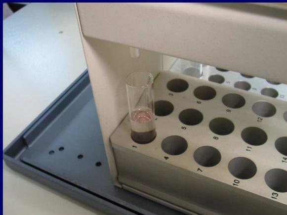
溶出:2M硝酸,銅及びコバルトを溶出
